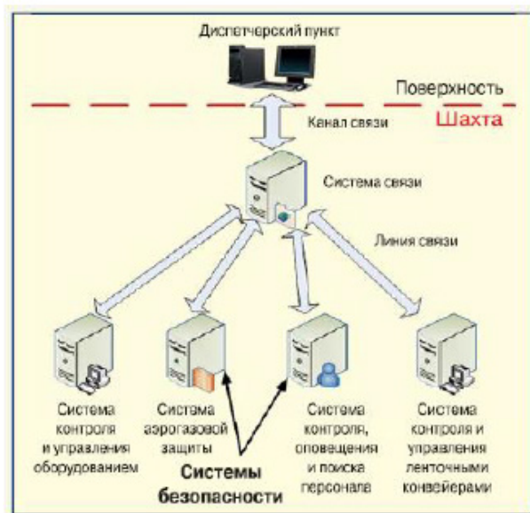
Рисунок 1 – Структура автоматизированной системы контроля и управления технологическими процессами
