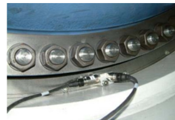
Сурет 5– негізгі мойынтіректегі CMS датчиктері
