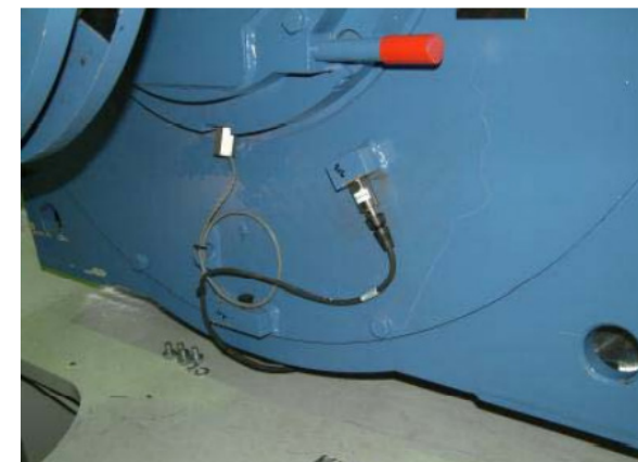
Сурет 7 – Генератордағы CMS сенсорлары
