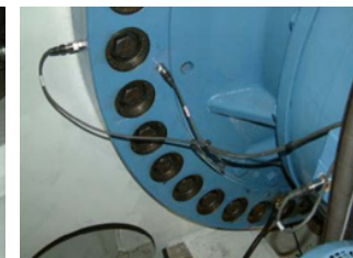
Сурет 6 – Беріліс қорабындағы CMS датчиктері
