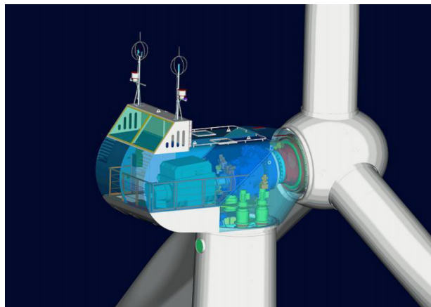
Сурет 1 – қуаты 2,05 МВт WTU 2.0 жел турбиасы
